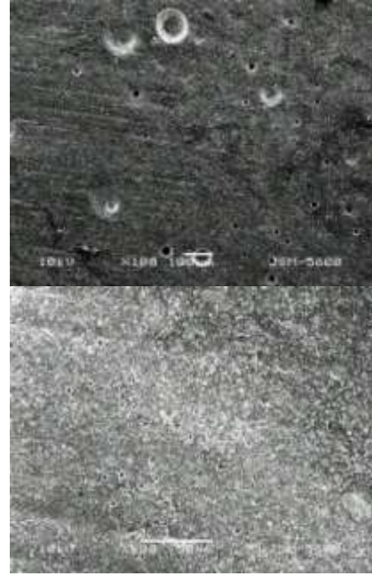
Figür 15. Sof-Lex disk ve cila lastiği ile cila işleminden sonra Katak Nano materyalinin x100 (a) ve x500 (b) büyütmede SEM fotoğrafları
