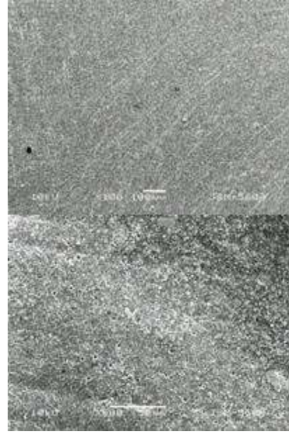
Figür 11. Sof-Lex disk ve cila lastiği ile cila işleminden sonra Vitremer materyalinin x100 (a) ve x500 (b) büyütmede SEM fotoğrafları
